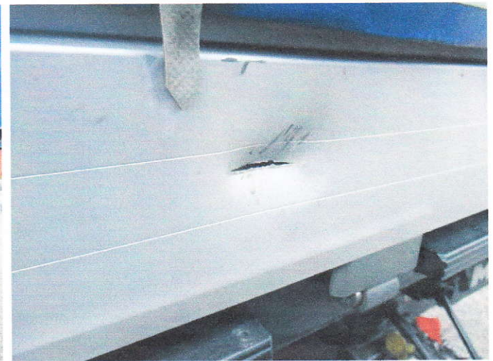
Uszkodzenie profilu aluminiowego tylnej burty skrzyni ładunkowej
